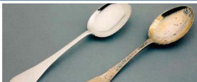
Figuur 102. Zilveren voorwerpen lopen aan; er wordt zilver sulfide gevormd. Omdat de concentratie waterstofsulfide ( H_2S ) en carbonylsulfide ( SCO ) in de lucht heel laag is en de reactie met het zilver razend snel is, wordt de snelheid van die reactie volledig bepaald door de snelheid waarmee de gassen het oppervlak bereiken. Onder normale condities is de eerste fase van aanlopen, een lichtgeel oppervlak, in ongeveer 0,5 tot 1 jaar zichtbaar.
