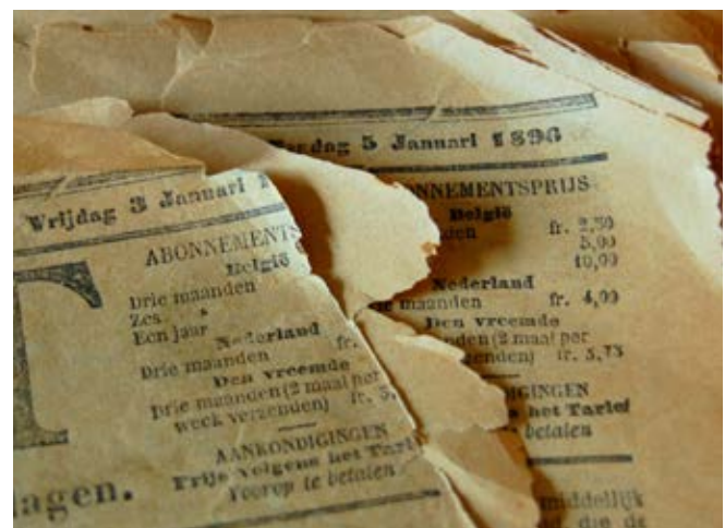
Figuur 82. Vergelde krant door UV-straling in daglicht
